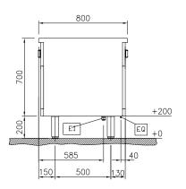
Electrical inlet (power) Equipotential screw
